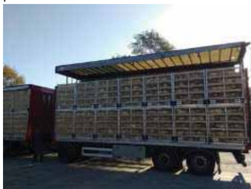
Figura 2.3 Camioanele pot avea acoperișuri care se pot ridica pentru a preveni stresul de căldură.
