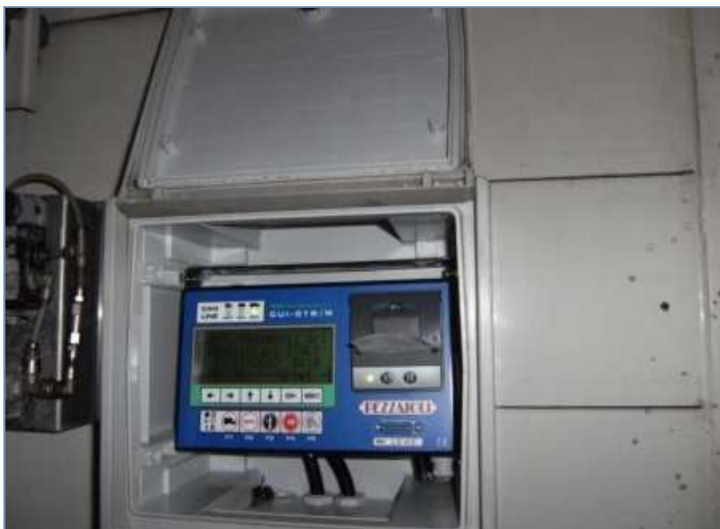
Figura 4.3 Vehiculele cu climă controlată și monitorizare automată permit un control mai ușor și mai precis al parametrilor de temperatură și de ventilație în interiorul compartimentului pentru animale.
